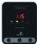
Exibe as condições de operação do nobreak, mostrando vários parâmetros, eventos e falhas. Com amplo visor, permite fácil leitura à distância. As informações exibidas são:
