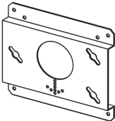
Suporte de parede para Nobreak Ragtech da Linha Save, pode ser utilizado em paredes de madeira, drywall, gesso e alvenaria. Podendo ser colocado em qualquer uma das laterais conforme instrução abaixo.
